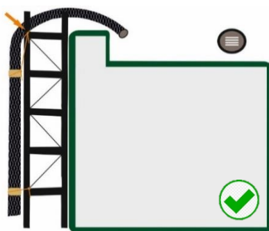
Schlauchfixierung mit Seil an den Schlauchverbindungen zum Abfangen der Zugkräfte
