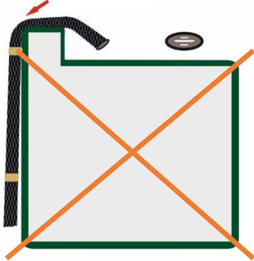
Querschnittsverengung an Dachkante
